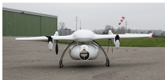
Messpod mit offenem Strömungsrohr und sichtbarer Messstrecke des optischen CO 2 -Sensors
