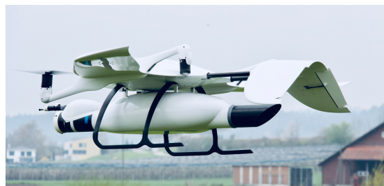
Wingcopter im Schwebeflug - Zwei Schwenkmotoren sorgen für den Schub im Streckenflug
